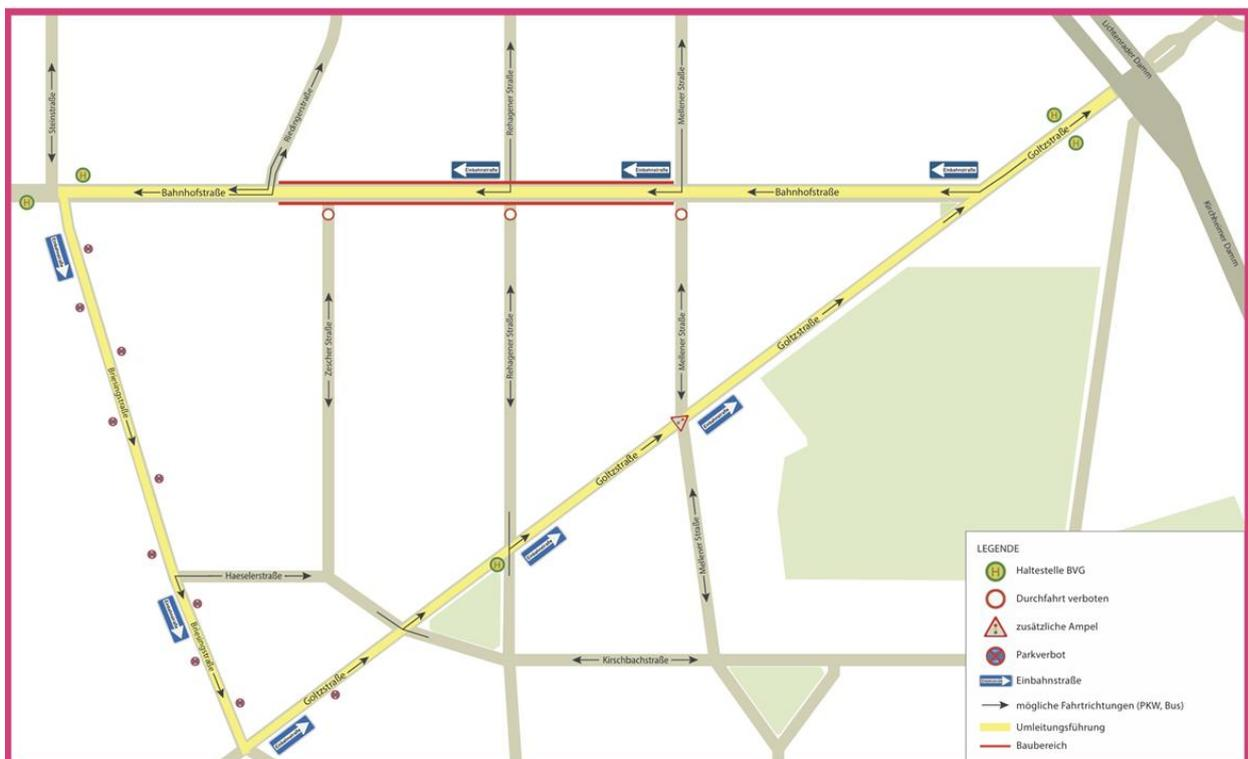
Abbildung: Umlenkungsplan 2. Bauabschnitt Bahnhofstraße
